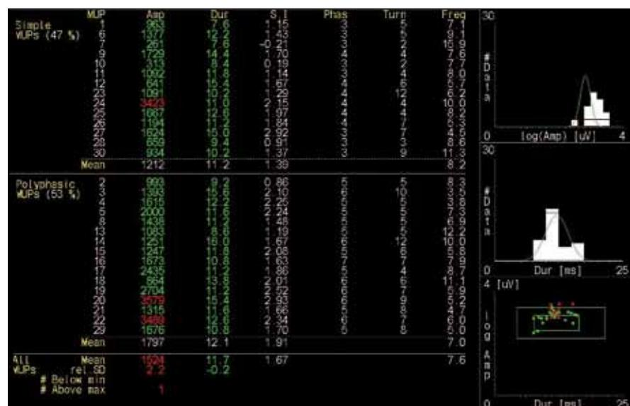
Obr. 2. Numerické parametry jednotlivých MUP s výpočtem průměrné hodnoty celého vzorku (abnormální hodnoty červeně), vpravo histogramy logaritmů amplitudy, trvání a bodový graf logaritmů amplitudy a trvání (zelené křivky znázorňují rozsah normálních hodnot, větší zelené obdélníky normativní hodnoty jednotlivých MUP, menší obdélníky normativní průměrnou hodnotu vzorku).
