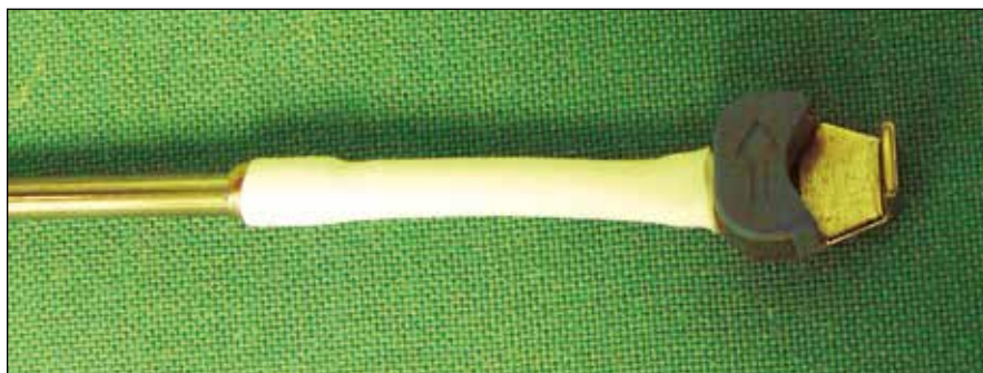
Obr. 3. Detail konce mikrosondy s tvarovatelným „krčkem“ a koncovým okénkem, do kterého je při operaci vložena tepna.
