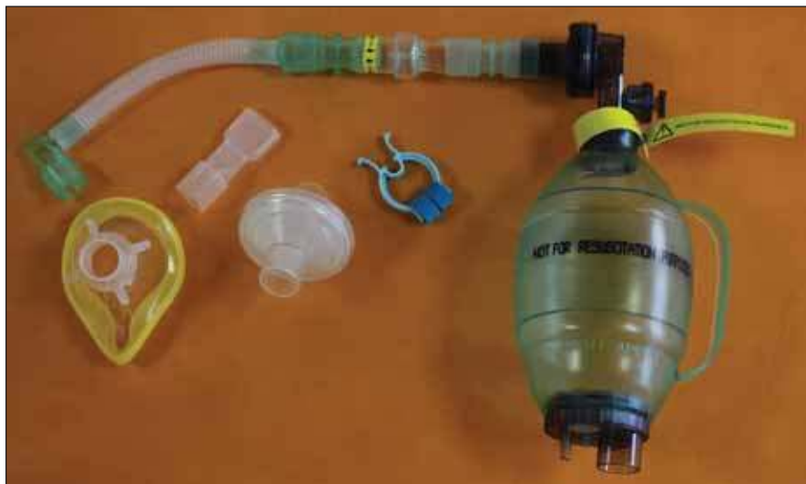
Obr. 6. Příslušenství k technice lung volume recruitment: ambuvak (který vzhledem k jednocestné chlopi není současně využitelný pro ev. resuscitaci), jednocestně usměrněná chlopi, bakteriální filtr, hadice. Na její konec lze pak nasadit náustek (při jeho použití je vhodné použít nosní klip) nebo obličejovou masku.
