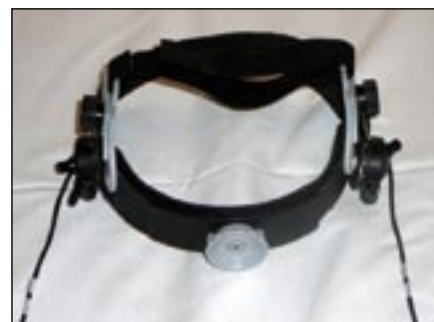
Obr. 5. Ultrazvukové sondy s fixačním zařízením.
