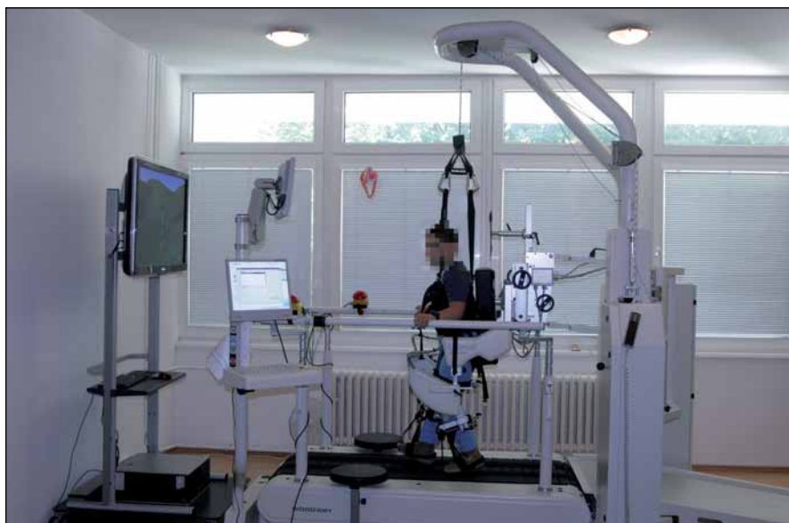
Obr. 1. Roboticky asistovaný lokomočný tréning v zariadení Lokomat®.
