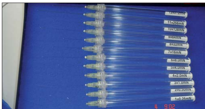
Obr. 2d) Sada kalibrovaných filament z optických vláken (fy. Marstock).
